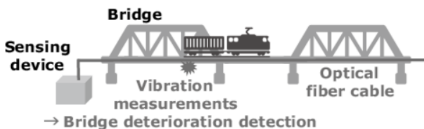
Figura 6: Rilevazione di deterioramento di un ponte in base alle vibrazioni misurate
